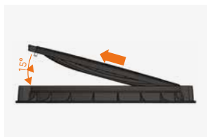
Для демонтажу кришки, кришка відкривається на кут до 15°, та витягується із замка шарніра
