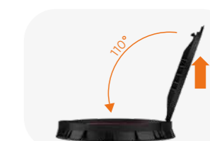
Щоб закрити люк, потрібно припідняти на 1 см вгору і продовжити закривання
