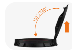
Щоб закрити люк, потрібно припідняти на 1 см вгору і продовжити закривання
