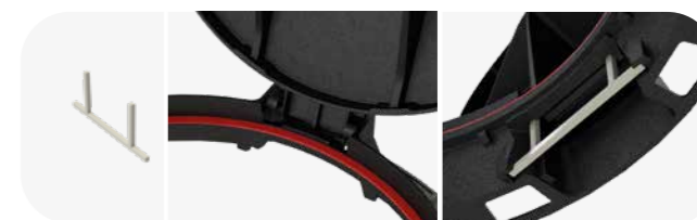
Антивандальна вставка (опція) встановлюється із зворотнього боку вушка в корпусі люка перед проведенням його монтажу.
